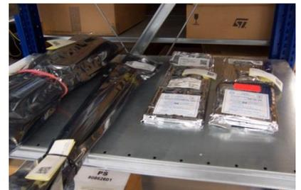
Auch außerhalb der EPA werden versandfertige Elektroniken in Shieldingbeuteln gelagert.
